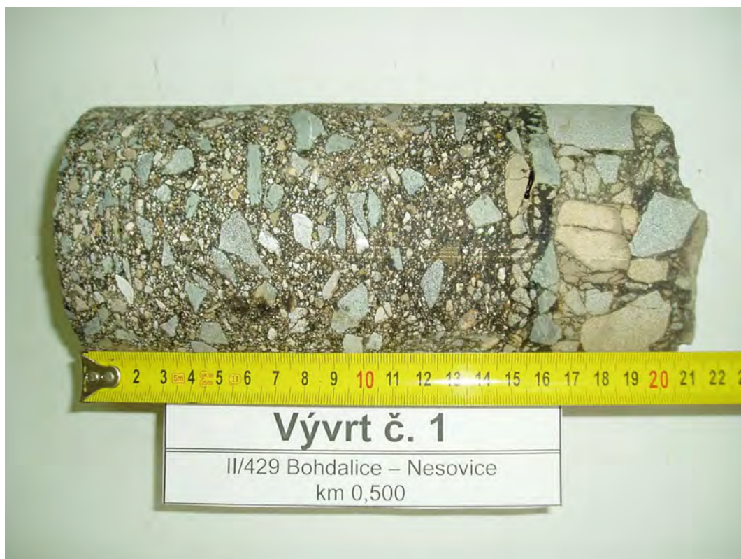
Foto č. 1 – Detail vývrtu č. 1
