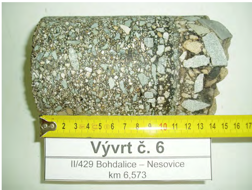
Foto č. 6 – Detail vývrtu č. 6
