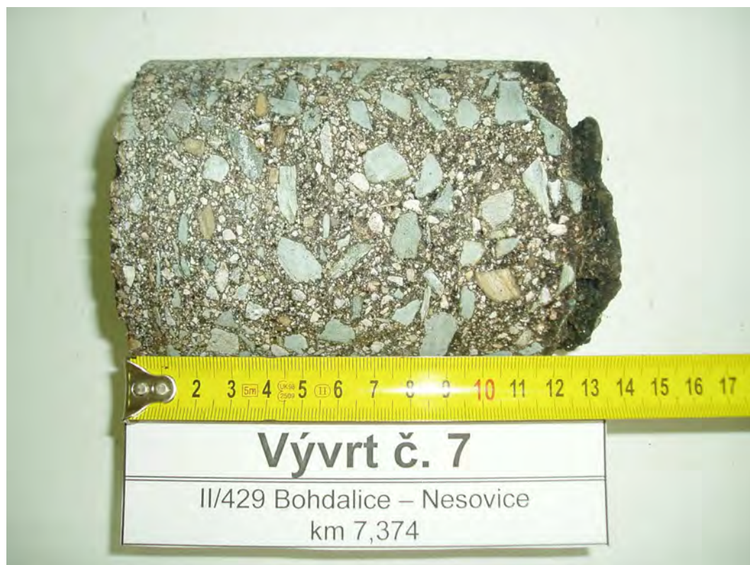
Foto č. 7 – Detail vývrtu č. 7
